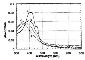
**Figure 5.** Photobleaching behavior of **BBD** crystal upon UV-irradiation (254 nm) for (a) 2 h, (b) 15 h, (c) 33 h, and (d) 47 h.
